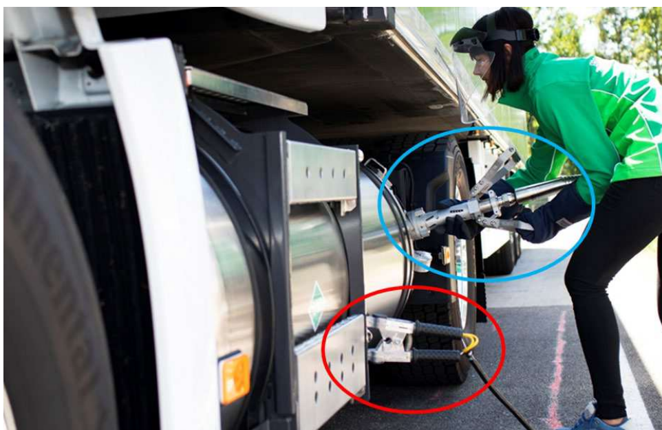
Abbildung 20: Lkw-Betankung. Blau: Tankstutzen, rot: Erdungskabel, Venting-Schlauch: nicht auf der Abbildung. Bildquelle: https://www.cng-mobility.ch/beitrag/lidl-weiht-erste-schweizer-lng-tankstelle-ein/
