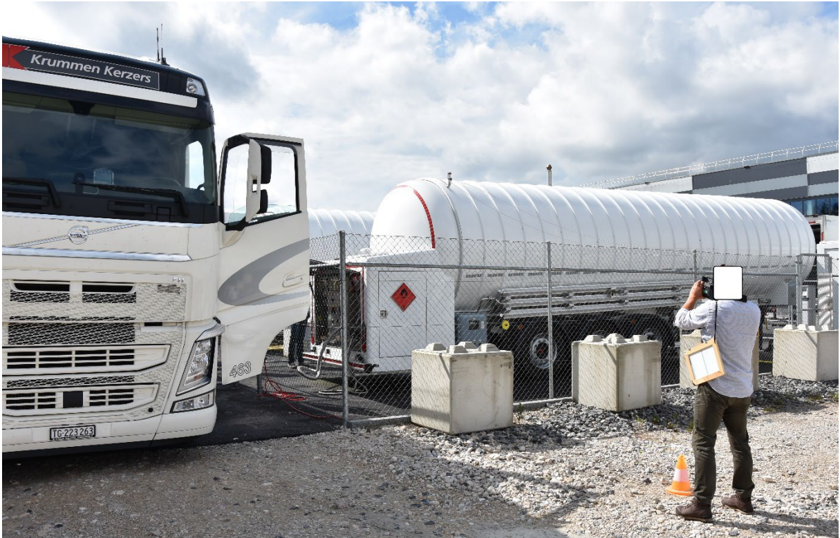
Abbildung 23: Messung von Methanemissionen mit einer Gas-Cam
