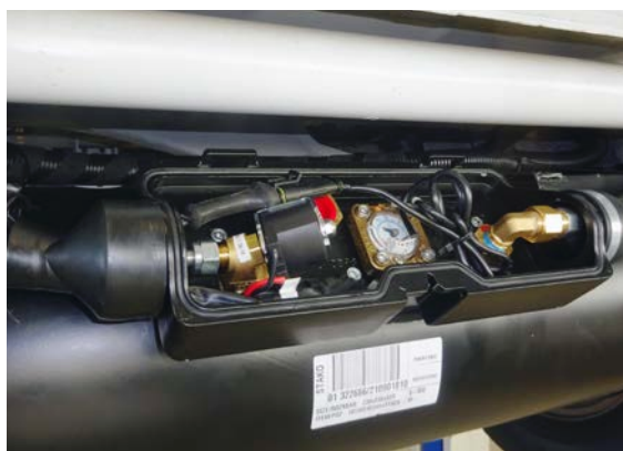
En cas de pression élevée, due à un réchauffement externe, une décharge de gaz peut se produire sur les réservoirs de GPL.
