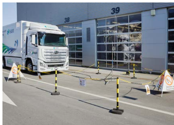
Lors de la décharge de gaz, la zone de sécurité doit être barrée.
