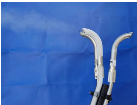
En cas d'immobilisation prolongée, une décharge de gaz peut se produire sur les réservoirs de GNL.
