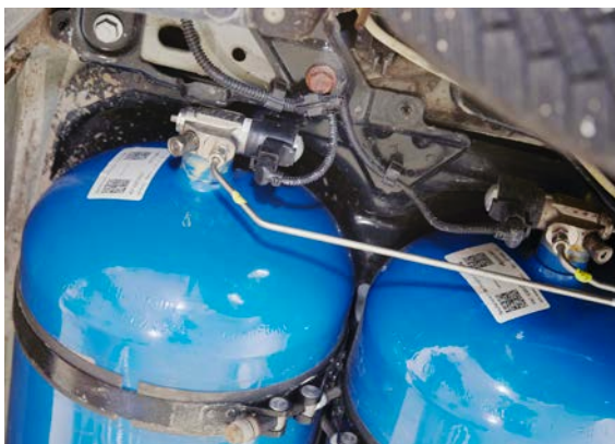
CNG wird bei 200 bar gespeichert.
