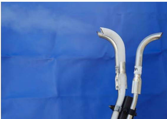
Bei längeren Standzeiten kann es bei LNG-Tanks zu einem Abblasen des Gases kommen.
