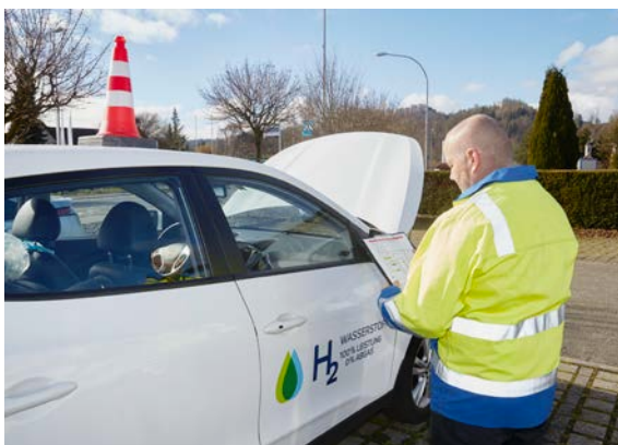
Gasfahrzeuge werden im Falle einer Panne mit einer Pylone auf dem Dach gekennzeichnet.
