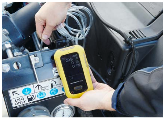
Mobile Gasdetektoren unterstützen die Suche nach Gaslecks.
