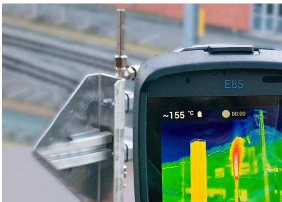
Wasserstoff ist farb- und geruchlos und verbrennt als unsichtbare Flamme.
